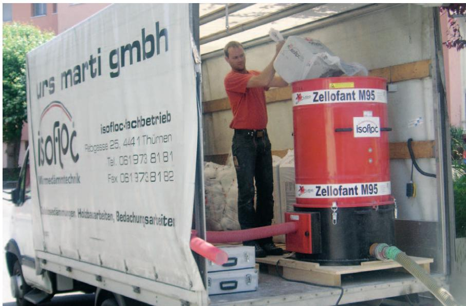
Aufgrund eines Messebesuches stieg bei Urs Marti das Interesse an isofloc. Dieses innovative Dämm- system aus der Schweiz überzeugte Marti, denn kaum ein anderes Produkt deckt Kälte-, Wärme-, Schall- und Umweltschutz in Einem ab. isofloc – 100% Altpapier – wird lose in Säcken angeliefert und mittels Luftdruck verarbeitet.
